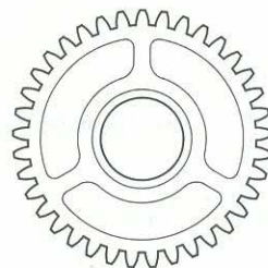
G4 × 1 37T プラギヤー 37T Gear 37Z Zahnrad Pignon 37 dents
